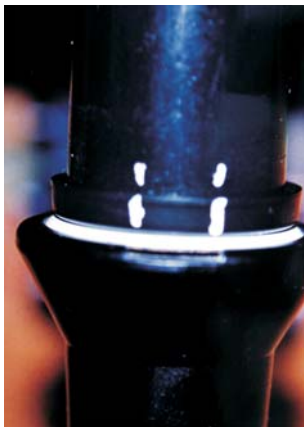
FIGURA 4 – Guias de orientação do cilindro coincidindo com as guias de orientação do colorímetro.
