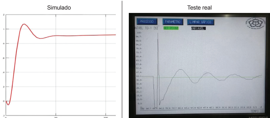
Figura 9 – Simulação e teste real na planta com controle pelo método ZN resposta ao degrau.
