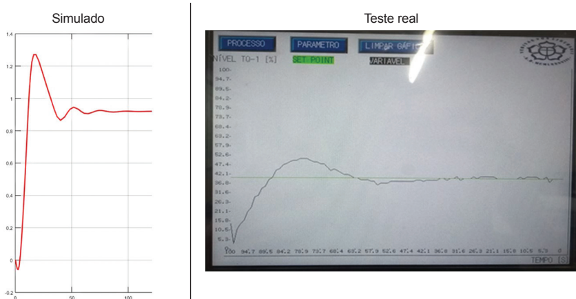
Figura 10 – Simulação e teste real na planta com controle pelo método CHR.
