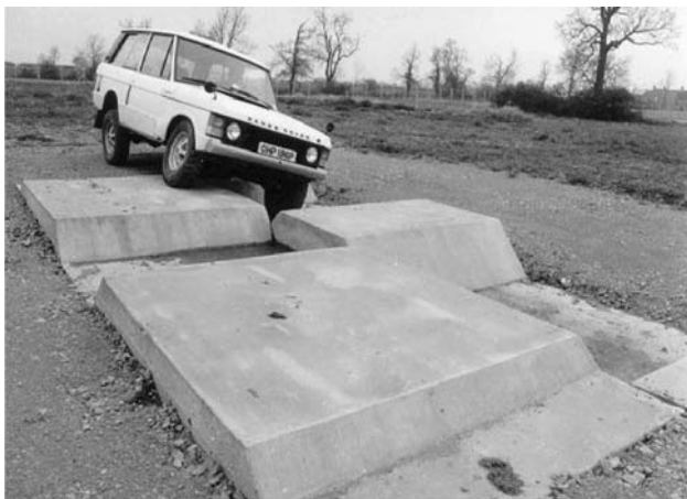
Figura 3. Torção aplicada ao chassi de um carro em uma pista de testes (Brown, 2002).
