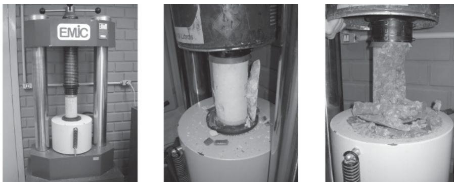
Figura 8 – Ensaio de resistência à compressão axial
