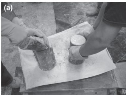
Figura 6 – (a) Concretos adensados em mesa vibratória e (b) concretos após moldagem
