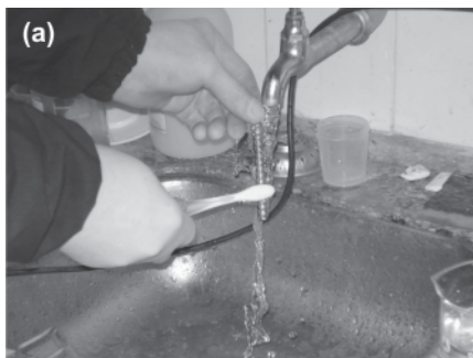
Figura 5 – (a) lavagem em água corrente das barras, escovadas com escova de cerdas plásticas e (b) secas com ar quente
