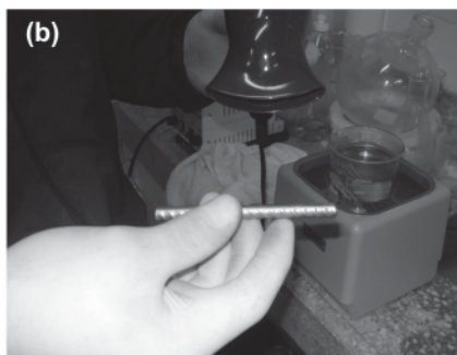
Figura 5 – (a) lavagem em água corrente das barras, escovadas com escova de cerdas plásticas e (b) secas com ar quente
