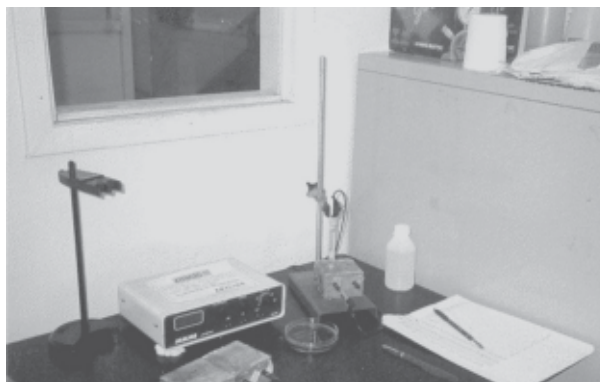
Figura 9 – Ensaio de potencial de corrosão
