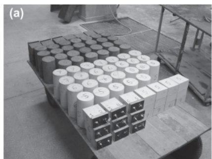
Figura 7 – (a) Corpos-de-prova desmoldados (b) c.p. na sala climatizada
