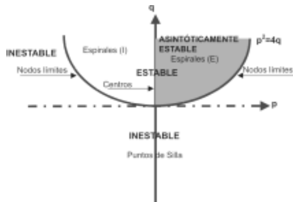
Figura 10. Resumen de las posiciones de equilibrio de un sistema lineal plano del tipo (5). Fuente: Del Autor.
