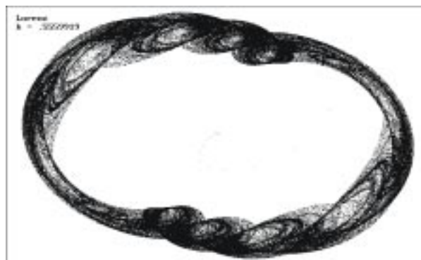
Figura 4. Soluciones del sistema x' = x - y - x^3 , y' = x - x^2y , usando el Método de Euler con h=0.5559919 . Fuente: http://sprott.physics.wisc.edu/chaos/eulermap.htm .
